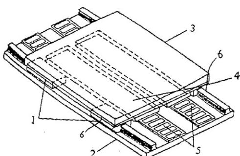
1、一种永磁式直线同步电动机，有定子和动子，其特征是：在定子与动子之间隔有隔磁铁板，铁板的厚度≤5mm。
